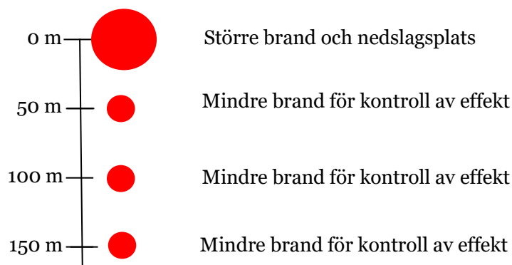
Figur 2. Utförande av provsprängningen.
